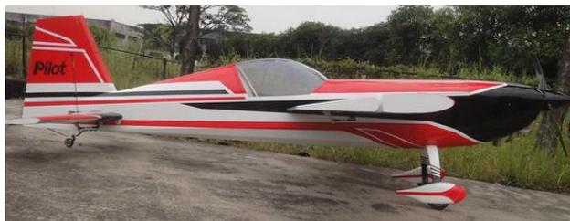
将陀螺仪转到锁定状态保持飞机从左到右平飞几秒钟后，突然一股上升气流将飞机头部往上顶，陀螺仪将迅速自动推舵将飞机转回平飞状态。如果少量推舵不足以将飞机转回平飞状态，陀螺仪将自动将升降舵保持推舵直到飞机回到平飞状态为止。由于整个动作过程是非常迅速的，飞行员都未必能观察到这个过程的发生。
