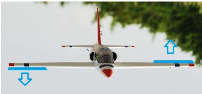
飞机在水平状态时，抬起左机翼，那么左副翼应该自动向上动作，右副翼应该自动向下动作。比如说：如果左副翼自动向下，说明左副翼反应错误，需要在陀螺仪上将左副翼做反向调整。
