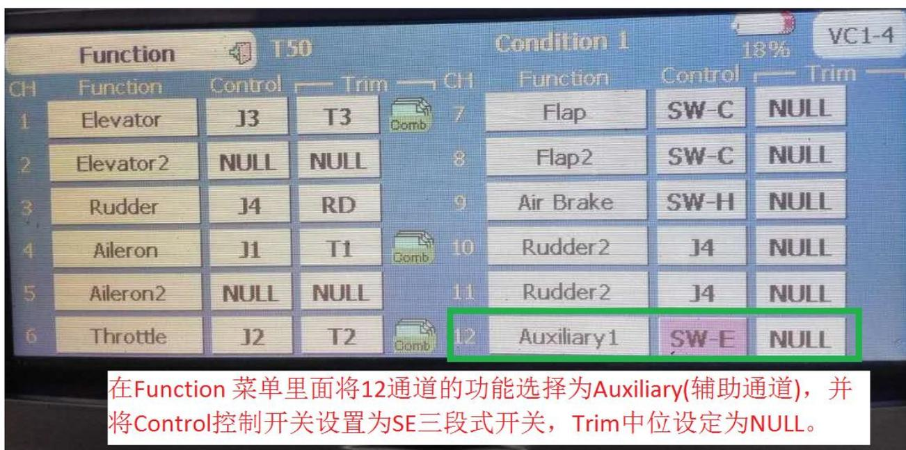
在Function 菜单里面将12通道的功能选择为Auxiliary(辅助通道)，并将Control控制开关设置为SE三段式开关，Trim中位设定为NULL。
