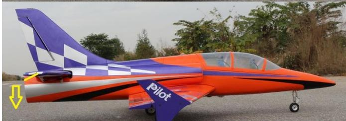
飞机在水平状态时，抬起机头，那么升降舵应该自动向下动作
