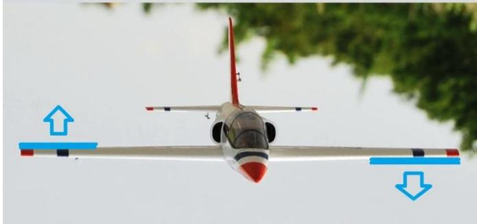
飞机在水平状态时，抬起右机翼，那么右副翼应该自动向上动作，左副翼应该自动向下动作。
